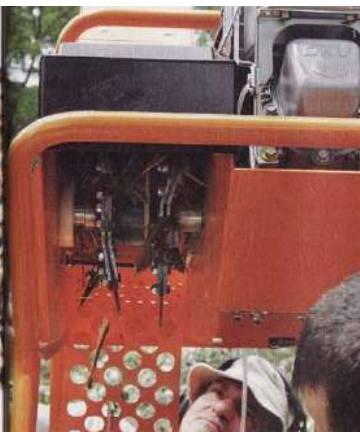
Changement de grille sur l'Eliet Maestro (à gauche). Deux chambres de broyage sur le gros Viking GB 460 (ci-dessus).
