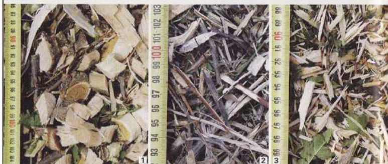
Les trois systèmes de broyage donnent des qualités de broyat très différentes. 1 - Petits tronçons et chapelets de bois frais pour Bosch, à utiliser en paillage. 2 - Broyat plus fin, mais petits brins intacts pour Viking. 3 - Broyat bien défilé pour Eliet.
